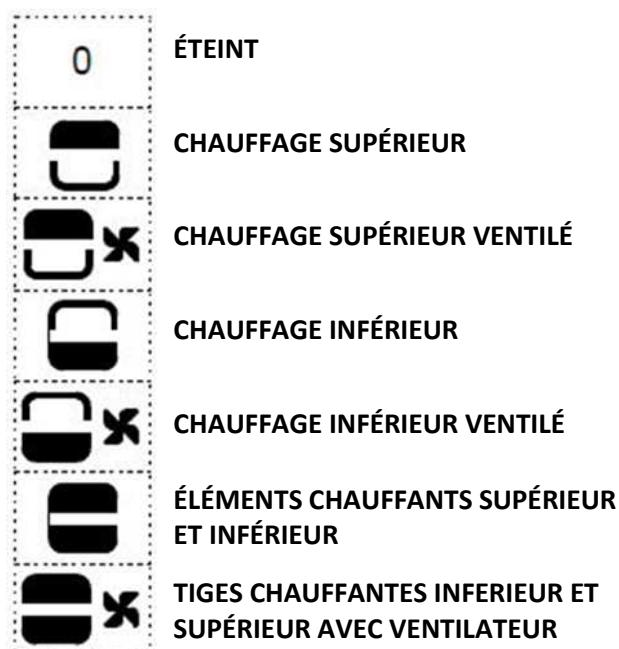
La manette de commande du thermostat a les positions d'utilisation suivantes:
