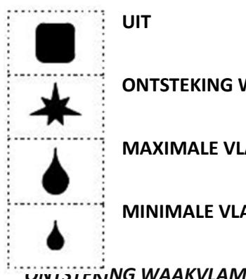
Druk de knop in en draai hem op de stand " ontsteking waakvlam ".
