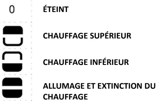
La manette de commande du thermostat a les positions d'utilisation suivantes:
